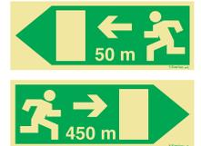
Un autre mode d'installation consiste à superposer les signaux avec en premier le signal informant l'issue de secours la plus proche
